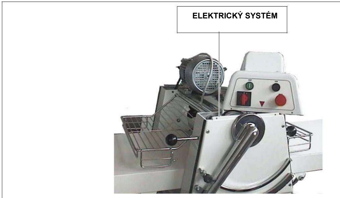
Obr. 4.2 Poloha elektrického systému
