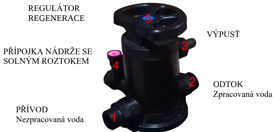
Obrázek 2. Popis řídicího ventilu.
